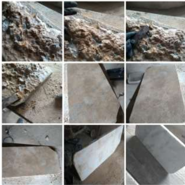
Fotografia 40: Vista da amostra da pedra com a remoção da argamassa após a neutralização do desincrustante;
